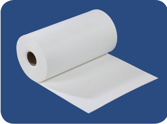
スーパーウールペーパーは、スーパーウールバルクと少量の有機バインダーから構成され、独自の抄造技術で製造されています。優れた断熱性を示し、柔軟性に富みます。また、切断、打抜きや、複雑な形状にも容易に加工でき、施工性に優れています。有機バインダーは、300℃以上に加熱されることにより燃焼して消失します。
